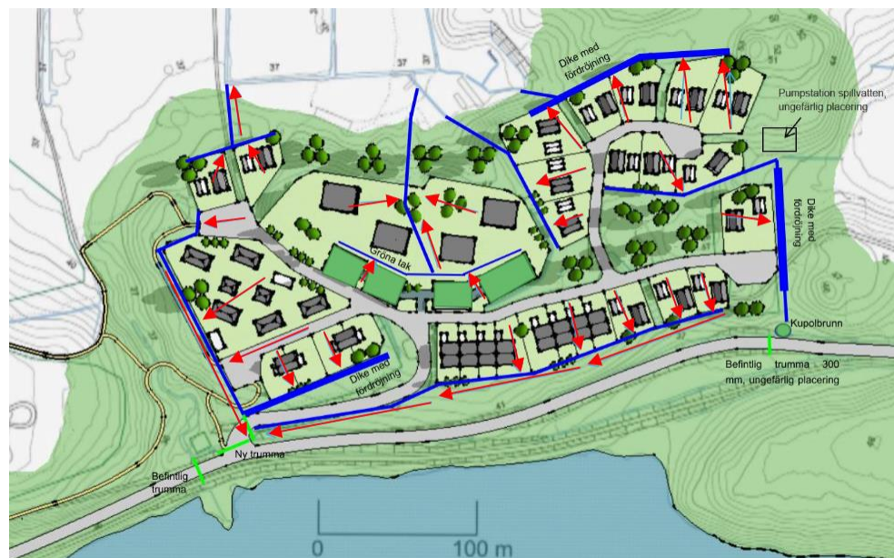
Principskiss över dagvattenlösning. Diken i blått med förslag till lutning av tomter med röda pilar.
